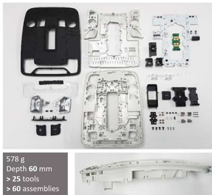
Figura 8: Elementos electrónica convencional para montar y ensamblar manualmente en una pieza real con curvatura.
