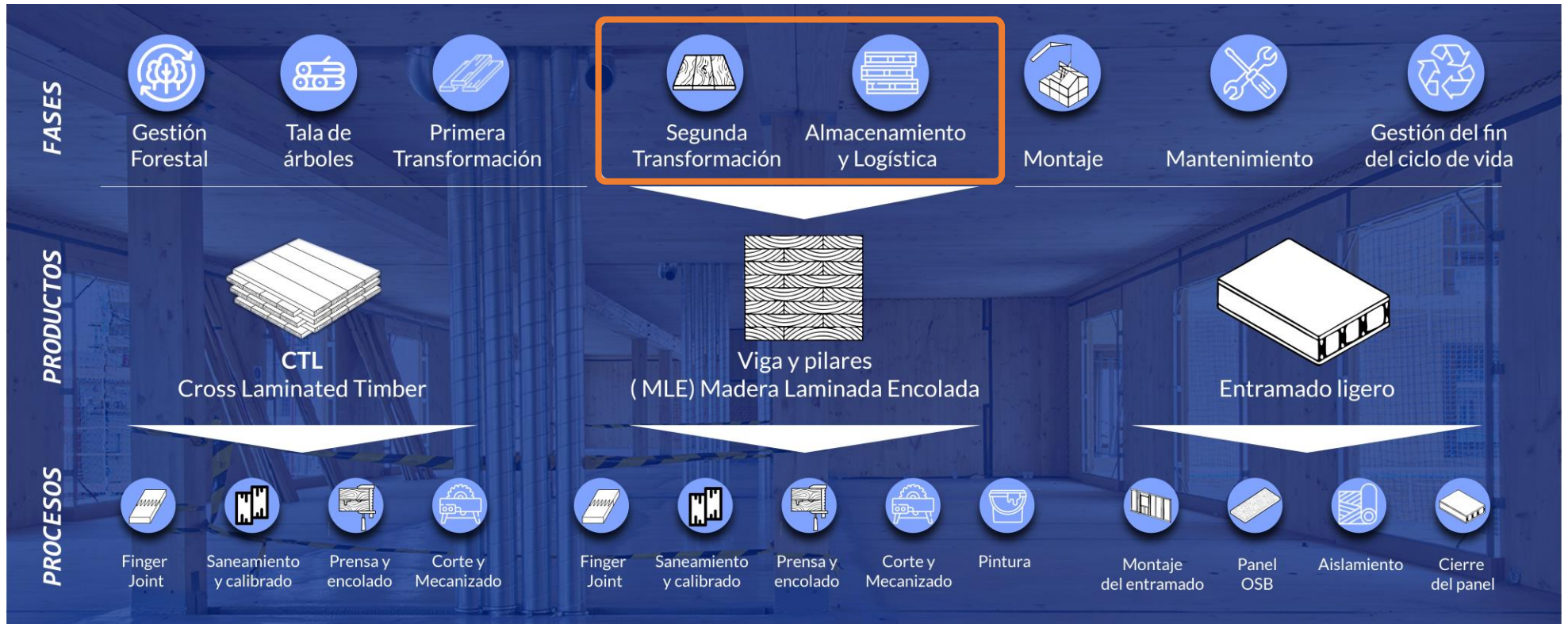
Ilustración 4. Alcance del reto dentro del proceso de fabricación y montaje de EGOIN
